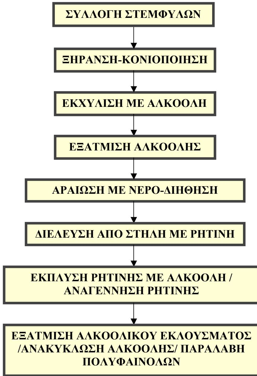
Σχήμα 25. Αρχή μεθόδου κατεργασίας με ρητίνες.
